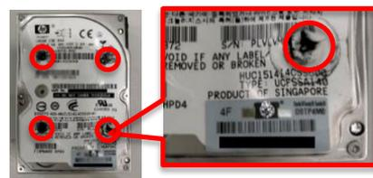
5トンの圧力がHDD中のプラッターまで及ぶ4点の穿孔をあげ、物理的に破壊します。
